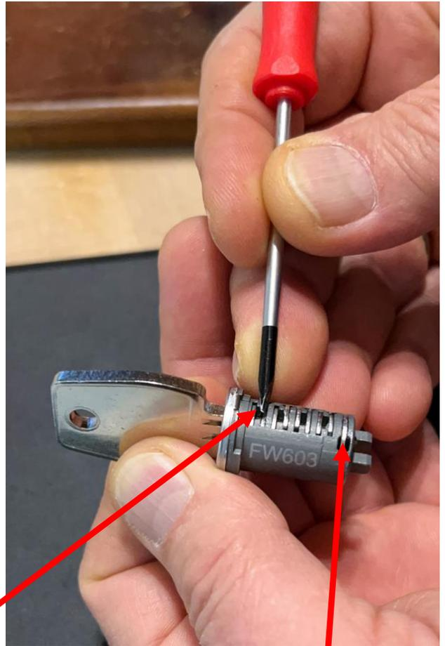
Zur Entsicherung diesen Stift (Zweiter) eindrücken und Schlüssel abziehen.
